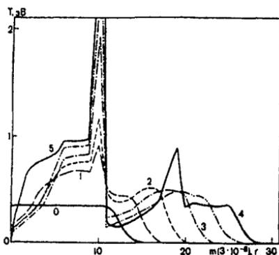
Рис. 3. Распределения температуры по массовой переменной к моментам времени, полученным в расчете, демонстрируют механизм возникновения  $T$ -слоев  $U_0 = 750$  В, 1-2 мкс, 2-4 мкс, 3-6 мкс, 4-8 мкс, 5-6 мкс
